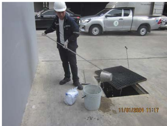
รูปที่ 3-5 การเก็บตัวอย่างคุณภาพน้ำทิ้ง บริเวณบ่อสูบน้ำทิ้งก่อนระบายออกนอกโครงการ
